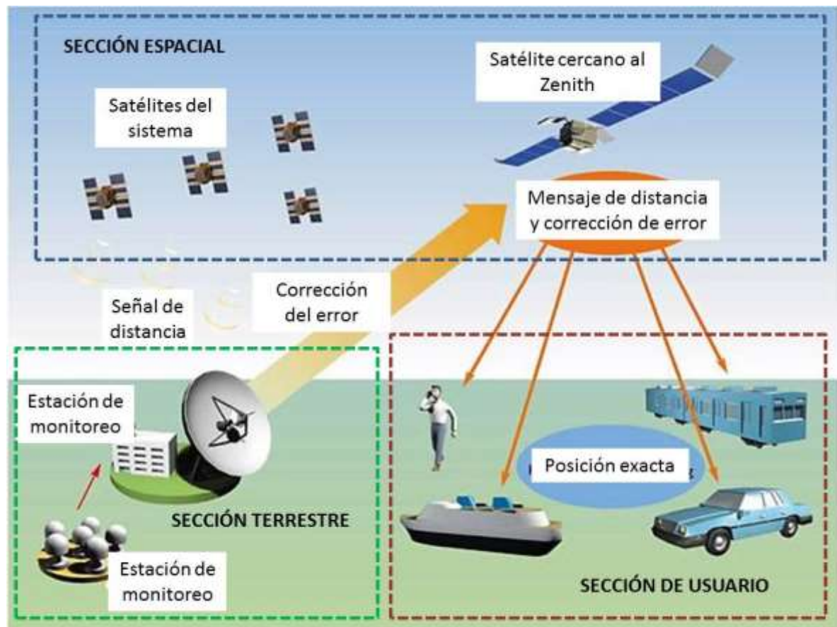
Componentes del sistema: sección espacial, sección terrestre o de control y sección de usuario.
